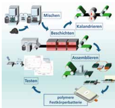
Geplante Prozesskette zur Herstellung polymerer Festkörperbatterien am Fraunhofer IGCV
