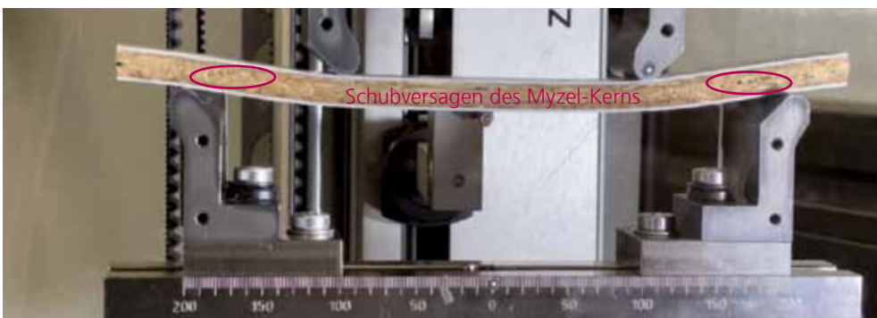
Myzel-GFK Sandwich Verbund im 4-Punkt-Biegeversuch
