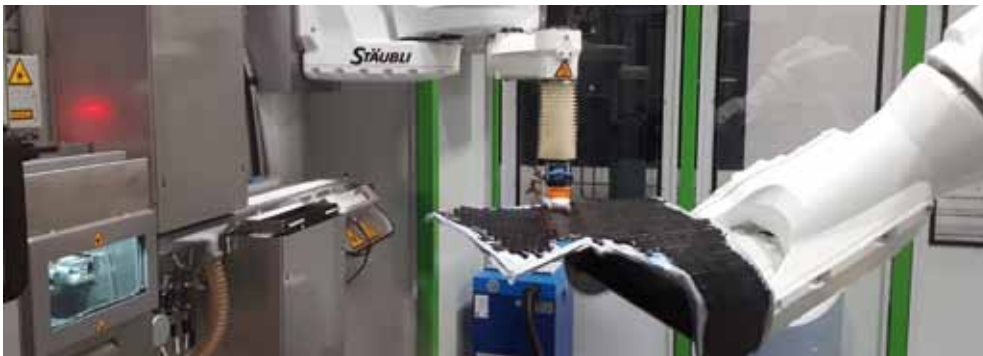
Fertigung einer CFK-Struktur mithilfe von Fiber Patch Placement
