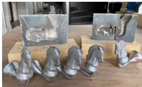
Eine erfolgreich mehrfach abgegossene faserverstärkte Sandgussform (links) und eine beim ersten Guss zerstörte unverstärkte Form (rechts)
