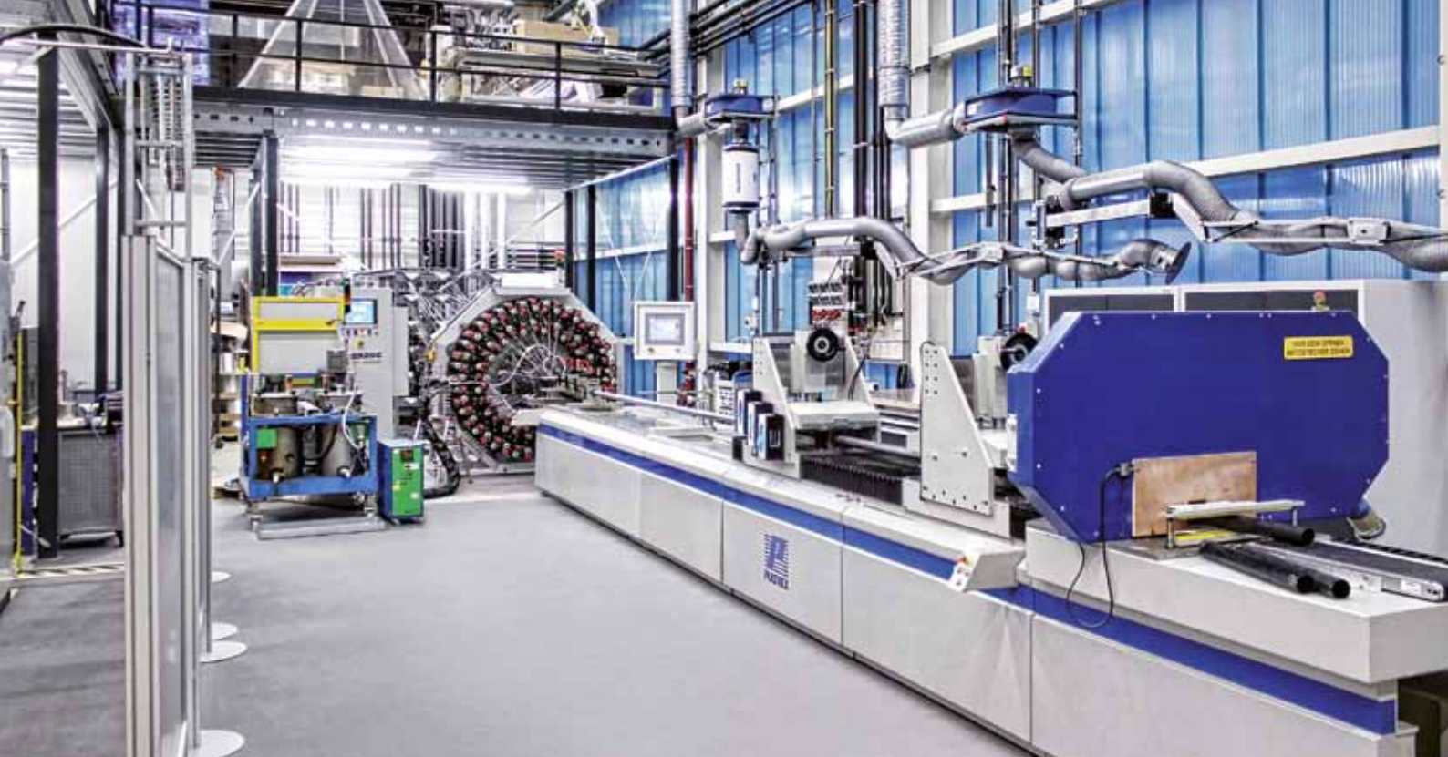
Pultrusionsanlage des Fraunhofer IGCV ausgestattet mit einem Flechter an der Faserzuführung zur Pultrusion und der Harzinjektionsanlage (links)
