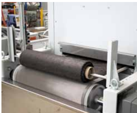
Vlies aus recycelten Carbonfasern, hergestellt mittels Nassvlies-technologie
