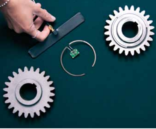
Mittels Additiver Fertigung hergestelltes Zahnrad mit integriertem Vibrationssensor und kontaktloser Datenübertragung
