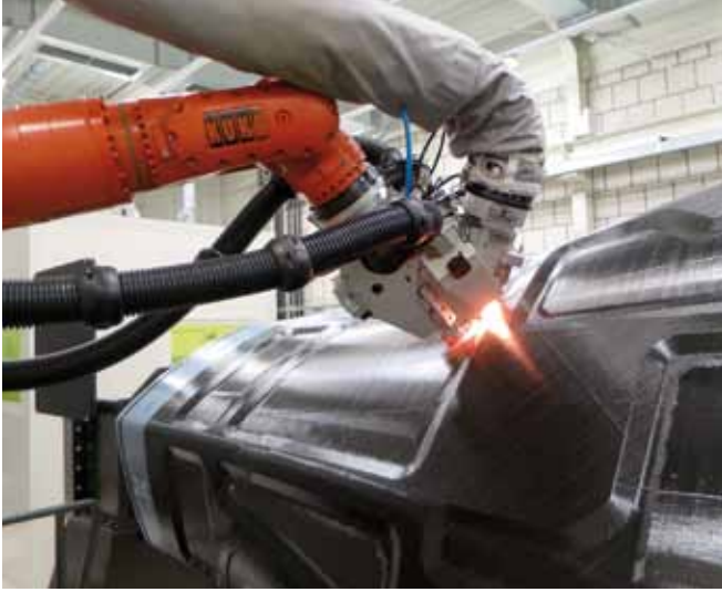
Herstellung einer Rumpfteilschale für den Prototypen des Hochgeschwindigkeits-hubschraubers RACER in AFP-Technologie (Automated Fiber Placement)
