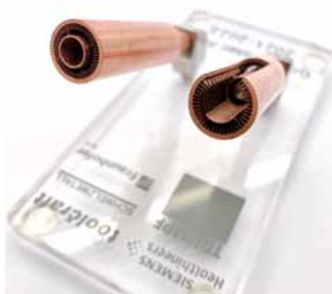
Bauteile nach Endbearbeitung aus CuCr1Zr (links) und Ausschnitt aus Reinkupfer (rechts)
