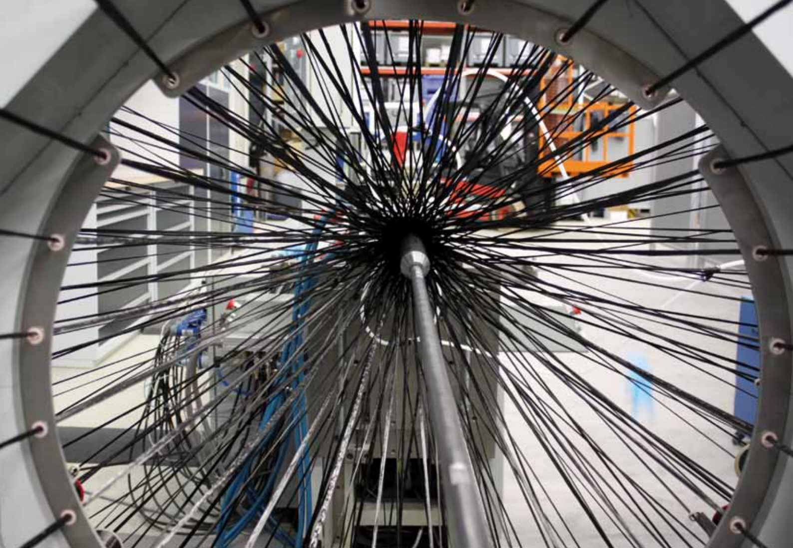
Pull-Braiding-Prozess zur Herstellung leistungsfähiger, dünnwandiger multiaxial-verstärkter Hohlstrukturen
