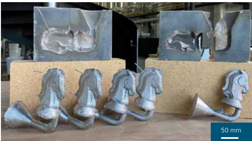
Projekt REINFORCED SAND: Mehrfach-Abguss mittels faserverstärkter Sandform (links); Bruch der Form ohne Verstärkungsfasern nach einem Abguss (rechts)
