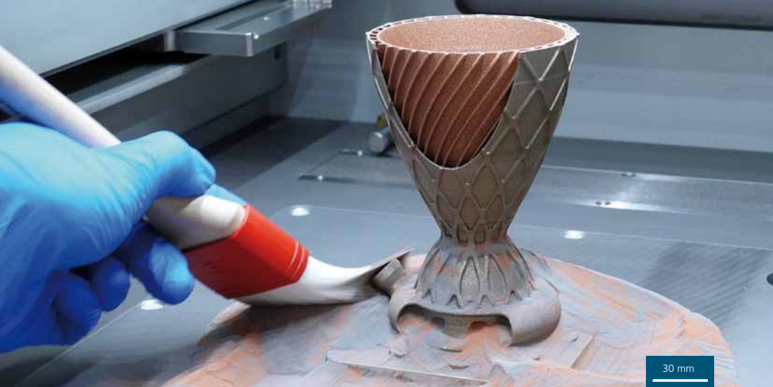
Projekt ACCURACY: Schnittmodell einer Brennkammer eines Raketentriebwerks mit integrierten Kühlkanälen in verkleinertem Maßstab aus den Werkstoffen CW106C und 1.2709, gefertigt im MM PBF-LBIM Prozess
