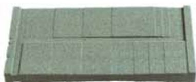
Behebung des Treppenstufeneffektes durch geometrieabhängige Binderverteilung: Die konventionellen Treppenstufen (links) können durch eine lokale Steigerung oder Senkung des Binderanteils aufgelöst werden (rechts).
