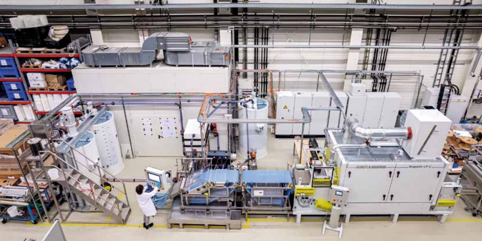
Nassvlies-Pilotanlage des Fraunhofer IGCV im Technikumsmaßstab für die Herstellung hochleistungsfähiger technischer Vliesstoffe in nahe-industrieller Produktionsumgebung
