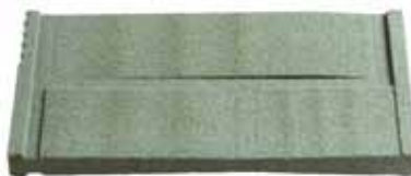
Behebung des Treppenstufeneffektes durch geometrieabhängige Binderverteilung: Die konventionellen Treppenstufen (links) können durch eine lokale Steigerung oder Senkung des Binderanteils aufgelöst werden (rechts).
