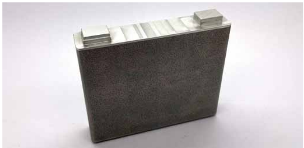
Additiv gefertigtes Batteriezellgehäuse aus der Aluminiumlegierung AlSi10Mg
