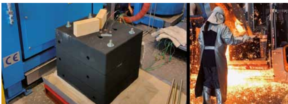
Abgussversuch mit Eisen in Gussform aus schwarzem Recycling-Sand am Fraunhofer IGCV Giesserei-Technikum in Garching
